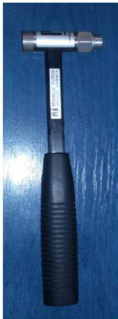
Rys.1 a) młotek modalny, b) wzbudnik elektrodynamiczny
