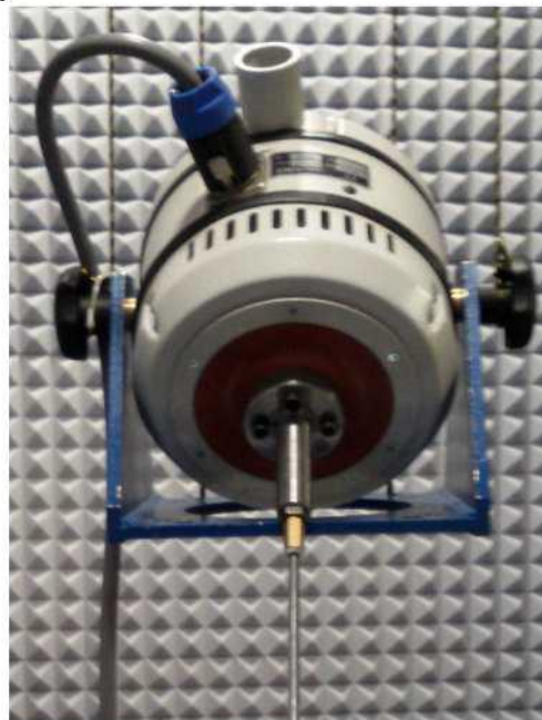
Rys.1 a) młotek modalny, b) wzbudnik elektrodynamiczny
