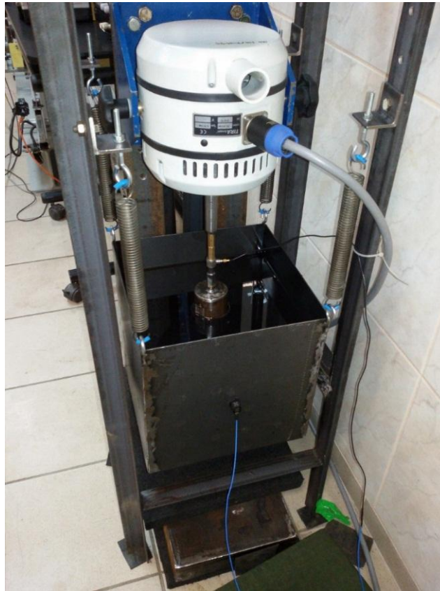
Rys.7 Badania przenoszenia drgań z poprzez olej na strukturę zbiornika.
