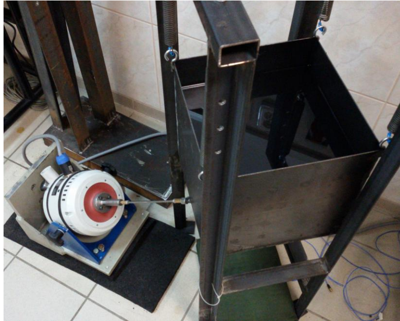
Rys.5 Badania wpływu oleju na drgania zbiornika
