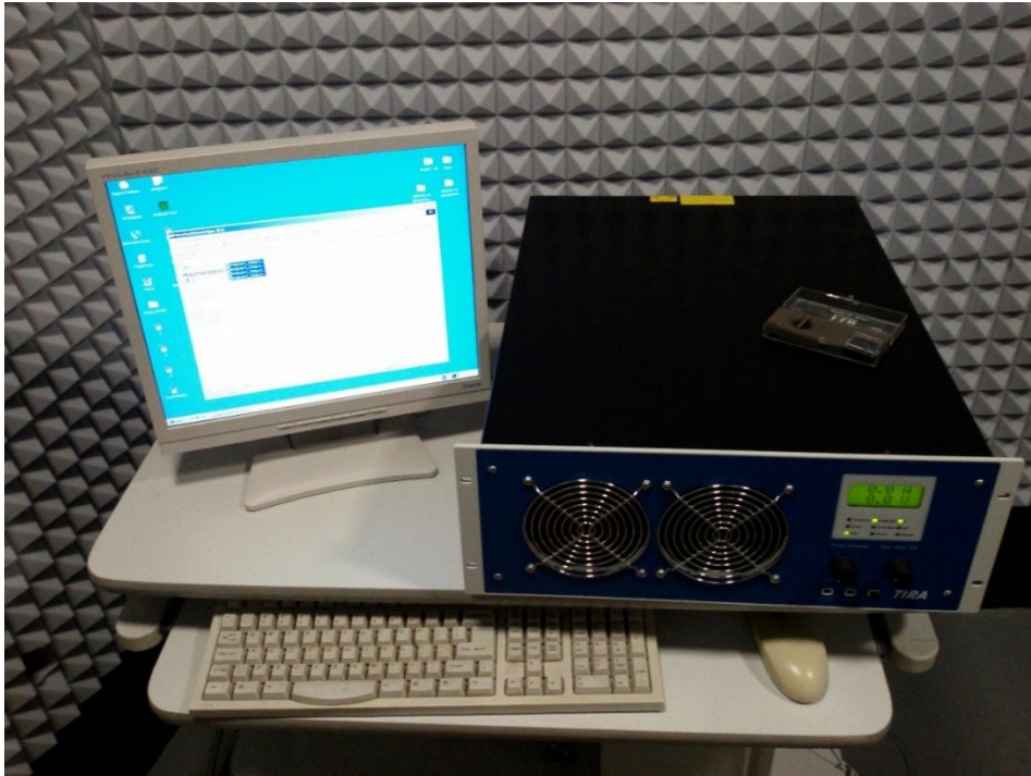
Rys.2 Komputer pomiarowy z wzmacniaczem wzbudnika
