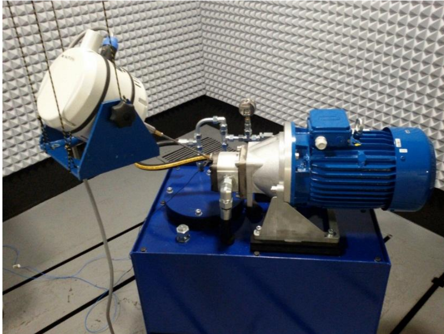
Rys.4 Układ przygotowany do przeprowadzenia analizy modalnej. Obiekt badań: Zasilacz hydrauliczny, Metoda wzbudzania drgań: Wzbudnik elektrodynamiczny.
